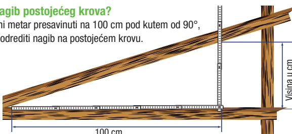
Očitajte visinu na drvenom metru i u tablici vidite nagib u stupnjevima:
