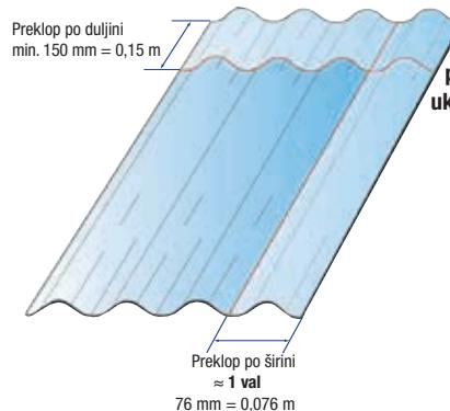
**Korisna površina je ona koja preostaje nakon što se površina preklopa oduzme od ukupne površine ploče!**
