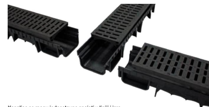
Kanalice se mogu jednostavno spajati u liniji i izrezivanjem je moguće spajanje bočno pod kutem od 90°. Kako bi se održala vodonepropusnost kanala, preporučuje se upotreba bitumenskih ili silikonskih brtivila. Zavarivanjem spojeva može se postići još bolja i dugotrajnija vodonepropusnost. Predviđeni isplusti s donje strane kanalice su promjera Ø75/Ø100 i Ø80/Ø110 mm. Zasebno se naručuje bočni završetak koji izrezivanjem nudi otvor za isplust promjera Ø50 / Ø60 mm.
